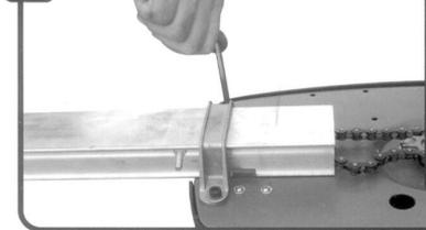
Inserire il profilo in alluminio nel corpo motore sino in battuta, far passare la catena attorno al pignone, montare il supporto di fissaggio e serrare le viti.
